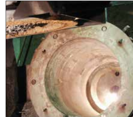
Der Ofen wird gereinigt und der Spulenputz wird überprüft.
