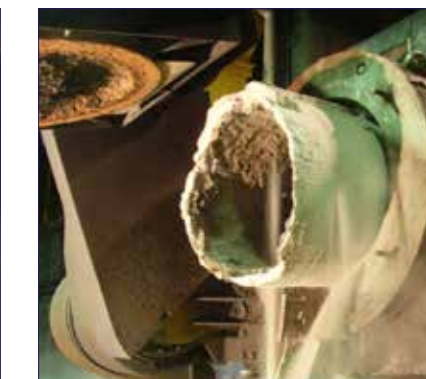
Der Tiegel wird ausgedrückt.
