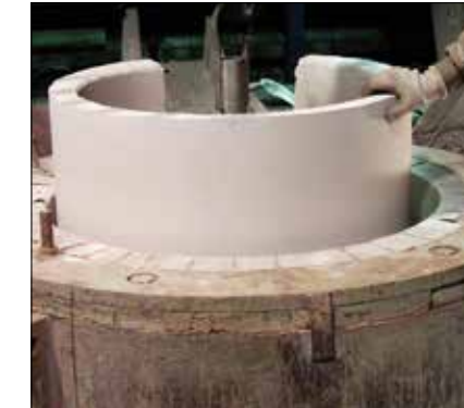
Der DORIT Fertigiegel wird mit Hilfe des Tiegelhebeegerätes eingesetzt.
