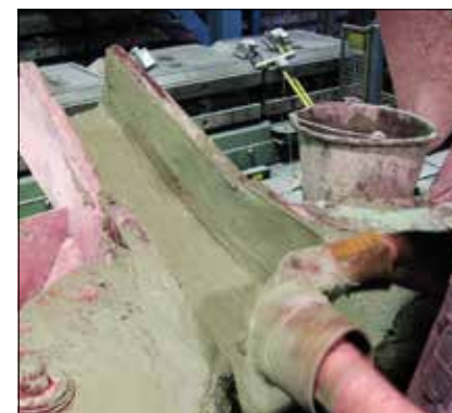
Die Gießschнауze wird den jeweiligen Gegebenheiten angepasst.
