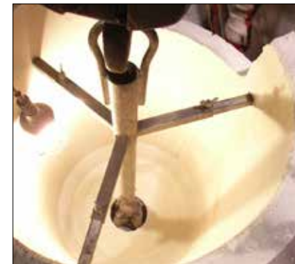
Das Tiegelhebeegerät wird herausgenommen.
