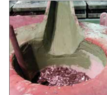
Induktiv mit Anfahrblock bzw. festem, stückigen Einsatzmaterial.
